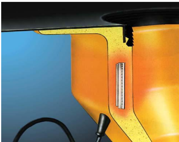
element grzewczy w ścianie wpustu
